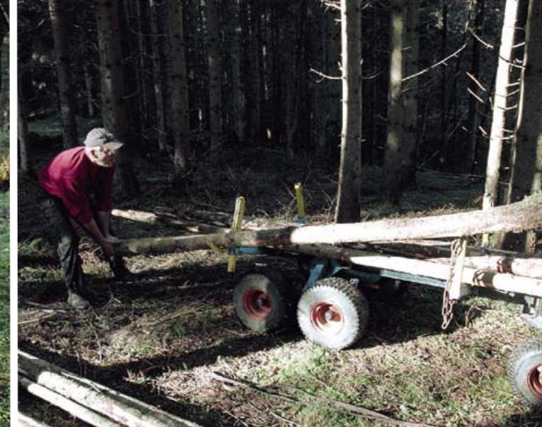
HJÄLPMEDEL 1. Med hjälp av en lastkrok kan Peter Andersson vicka stammarna upp på åttahjulingen.
