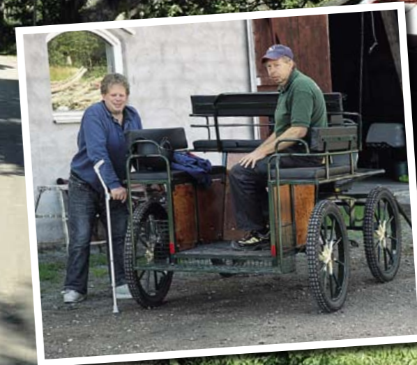
SÅKERT. Vagnen som används i Hermanssons körverksamhet är en specialbeställd Tidaholmsvagn. Den har skivbromsar på hjulen och täckt passagerardel.
